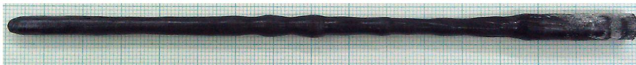
Рис. 1. Кристалл натриевого кобальтата  $\text{Na}_{0.75}\text{CoO}_2$ .
